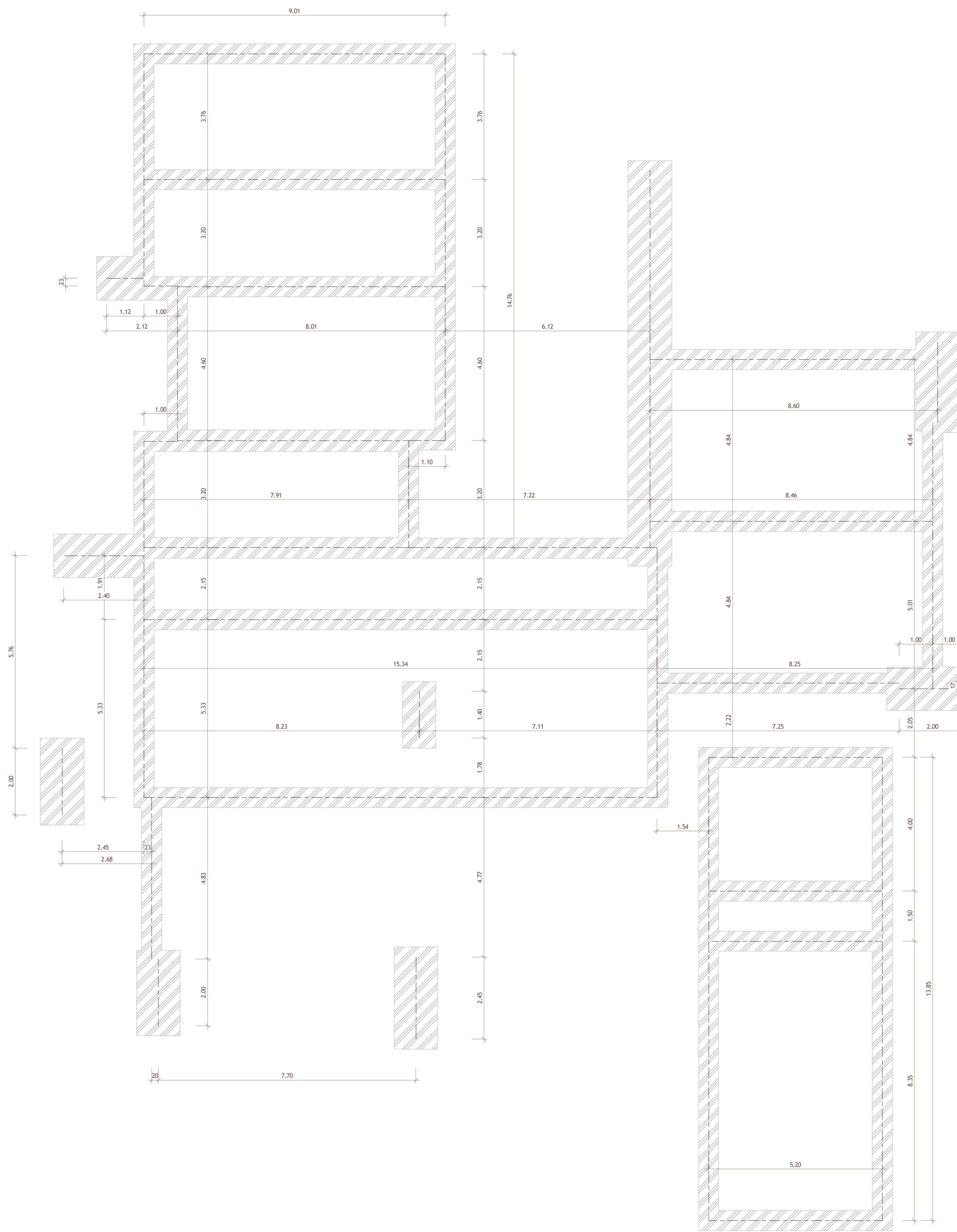
Il s'agit d'un plan de fondations montrant les semelles filantes en béton cotés à l'axe. Il doit être adapté aux conditions spécifiques du sol, aux matériaux de construction de la maison, à l'environnement et aux différentes charges structurelles. La validation de ce plan par un ingénieur en structure, ou par votre entrepreneur s'il est qualifié, est obligatoire avant la construction.
